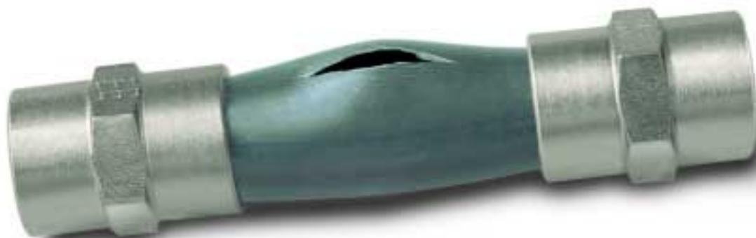
*Prova distruttiva con tubo in acciaio al carbonio 22x2
