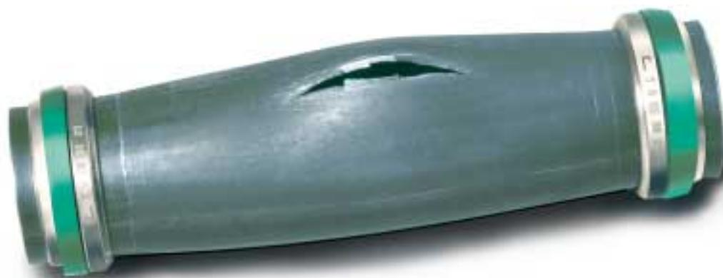
*Prova distruttiva con tubo in acciaio al carbonio 28x2.
