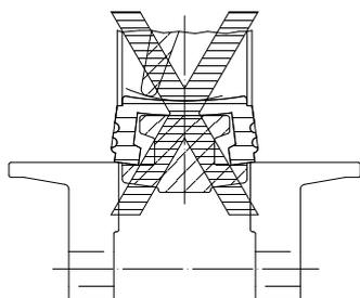
Esempio di montaggio non corretto: le flange non sono sufficientemente aperte, la guarnizione può deteriorarsi.
