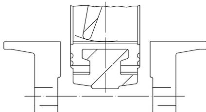
La distanza tra le flange deve permettere l'introduzione della valvola senza che la guarnizione interferisca con le stesse. Durante l'operazione la farfalla deve trovarsi in posizione semichiusa.
